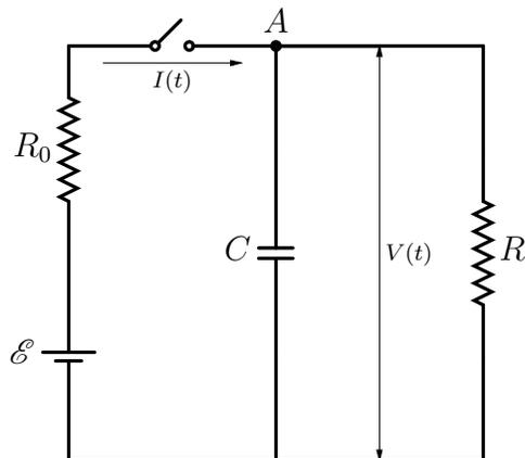
**Inizialmente il condensatore è scarico; calcolare la differenza di potenziale ai suoi capi,  $V(t)$ , a partire dall'istante in cui l'interruttore viene chiuso.**
