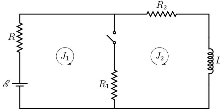
Il circuito sta funzionando da  $t = -\infty$  con l'interruttore aperto. Al tempo  $t = 0$  l'interruttore viene chiuso. Calcolare le correnti.
