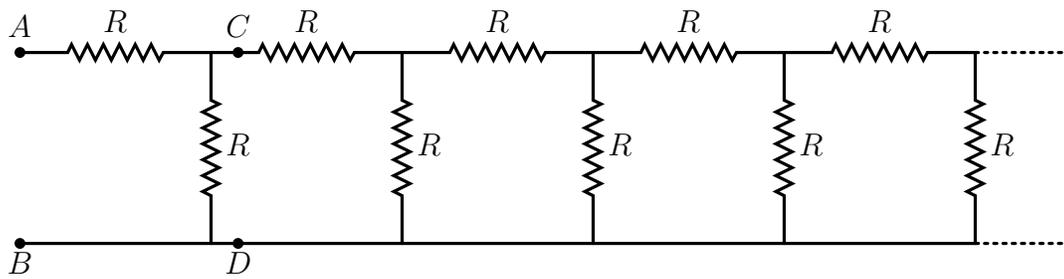
La linea è semiinfinita, cioè la cella elementare di due resistenze è ripetuta a destra infinite volte. Data  $R$ , vogliamo calcolare la resistenza misurata ai capi  $A$  e  $B$ ,  $R_{AB}$ .
