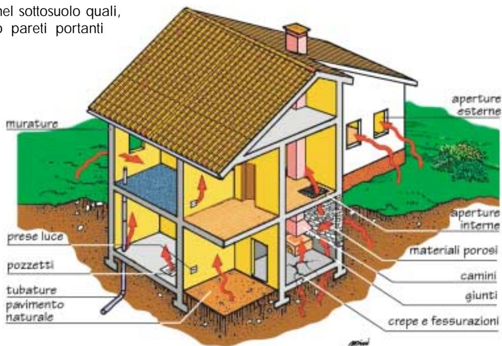
Fig. 3 - Punti d'infiltrazione del radon nell'edificio
