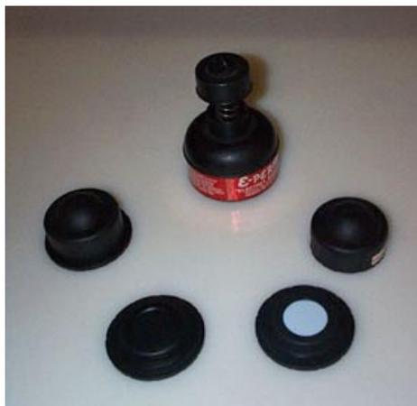
**Figura 3 - Sistema di misura passivo ad elettreti**
