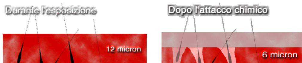
Figura 1 - Formazione e sviluppo delle tracce nucleari
