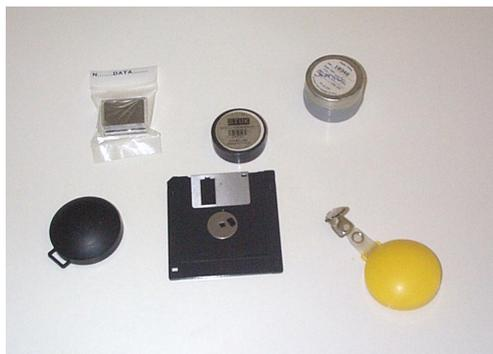
**Figura 2 - Dispositivi a tracce per la misura della concentrazione di radon**
